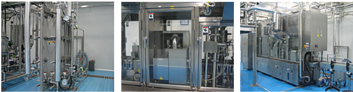
UHT 殺菌機 (朝日緑源乳業公司HPより) ESL 殺菌ユニット (同) ESL 充填機 (同)
