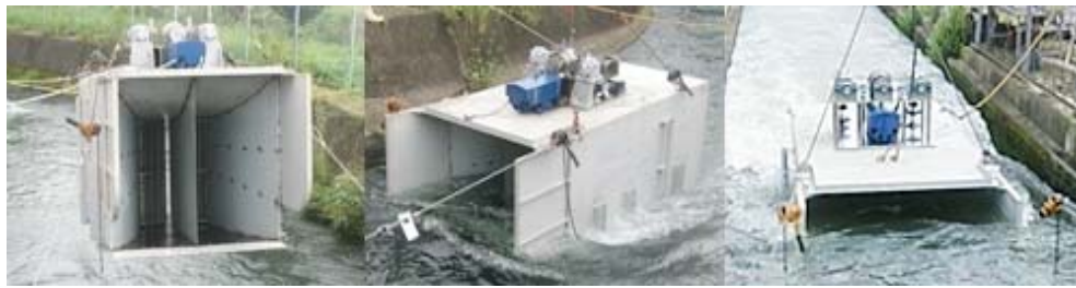
図6 流水式小水力発電機
