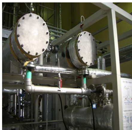
ゼオライト膜によるエタノール/水分離膜装置(筆者撮影)
