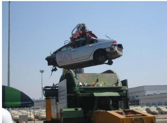
(写真) 冠水した自動車のスクラップ作業
