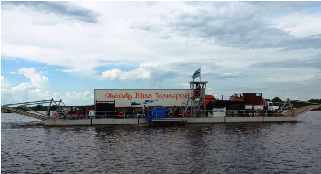
(写真) コンテナトラックを輸送するポンツーン
